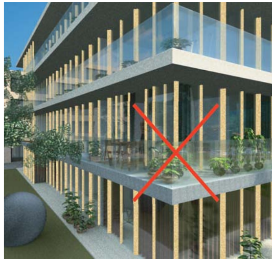
Aquestes plantes en test no estan posades just al darrere de superfícies transparents, però s'haurien de col·locar encara més enrere. La vegetació excessiva en hivernacles i edificis envidrats també és un perill.
